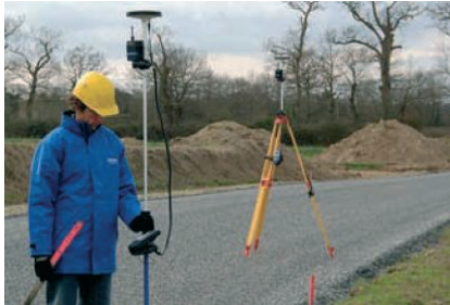
Sl.8b) Bazni GPS prijemnik i rover u ruci geodete
